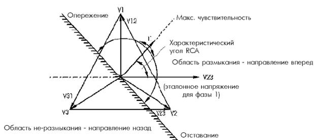
Рисунок 4.6: Область TRIP/NO-TRIP для модуля определения направления блока MRI3. В этом случае прямое направление определяется как область TRIP, а обратное направление – как область NO-TRIP.
