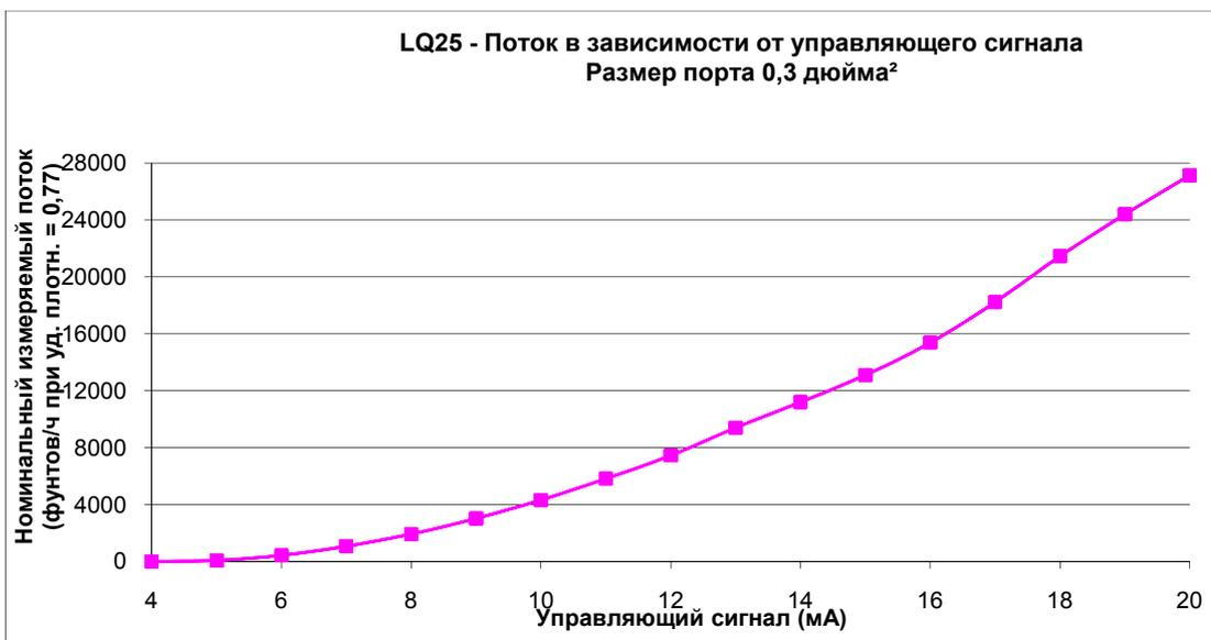
Рисунок 1-3. LQ25 - Зависимость потока от управляющего сигнала
